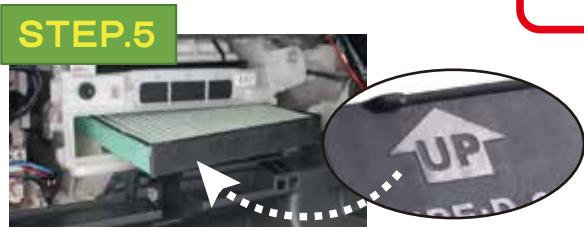
フィルターの矢印マーク(↑)を上方向にしてセットし、取り外された部品を逆の手順で戻してください。
