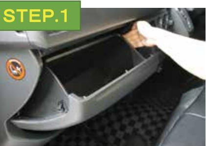
グローブボックスを開けたら、運転手側へ手を入れて内側へ引いてツメを抜いて下さい。
