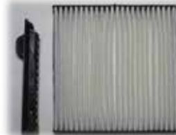
切り出した前面フラップ部分です。「エムリットフィルター」と「フラップ」 配置方向です。
