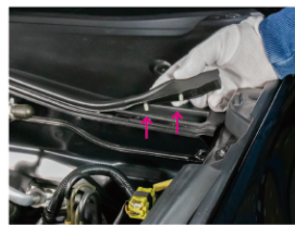
④ウェザーストリップを固定している爪(5か所)をつまみながらカバーから外します。
