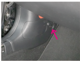
②左下部の内張のクリップを外します。
