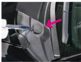
①フロントウィンドウ助手席側、ボンネットの間のカバーのキャップを外します。
