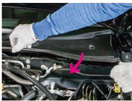
⑦トップカバーを外します。手前を車体前方へ引きながら、最後に上に持ち上げます。
