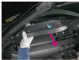
⑤Aピラーカバーを斜め下側方向へ引っ張り、外します。
