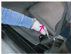
①助手席側、スカッフプレートを手体後方側から上方向に引き上げて外します。
