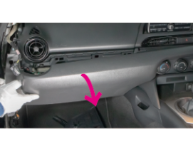
⑦ロアパネルを手体後方へ引っ張り外します。
