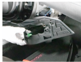
④左下部の内張を手体後方へ引っ張り外します。(緑のクリップで留まっています)
